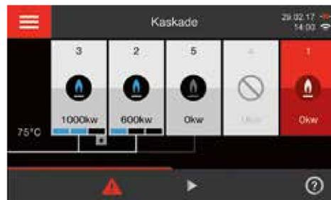
Display der Vitotronic 300 (Typ CM1E) für Mehrkesselanlagen mit bis zu 8 Einheiten
